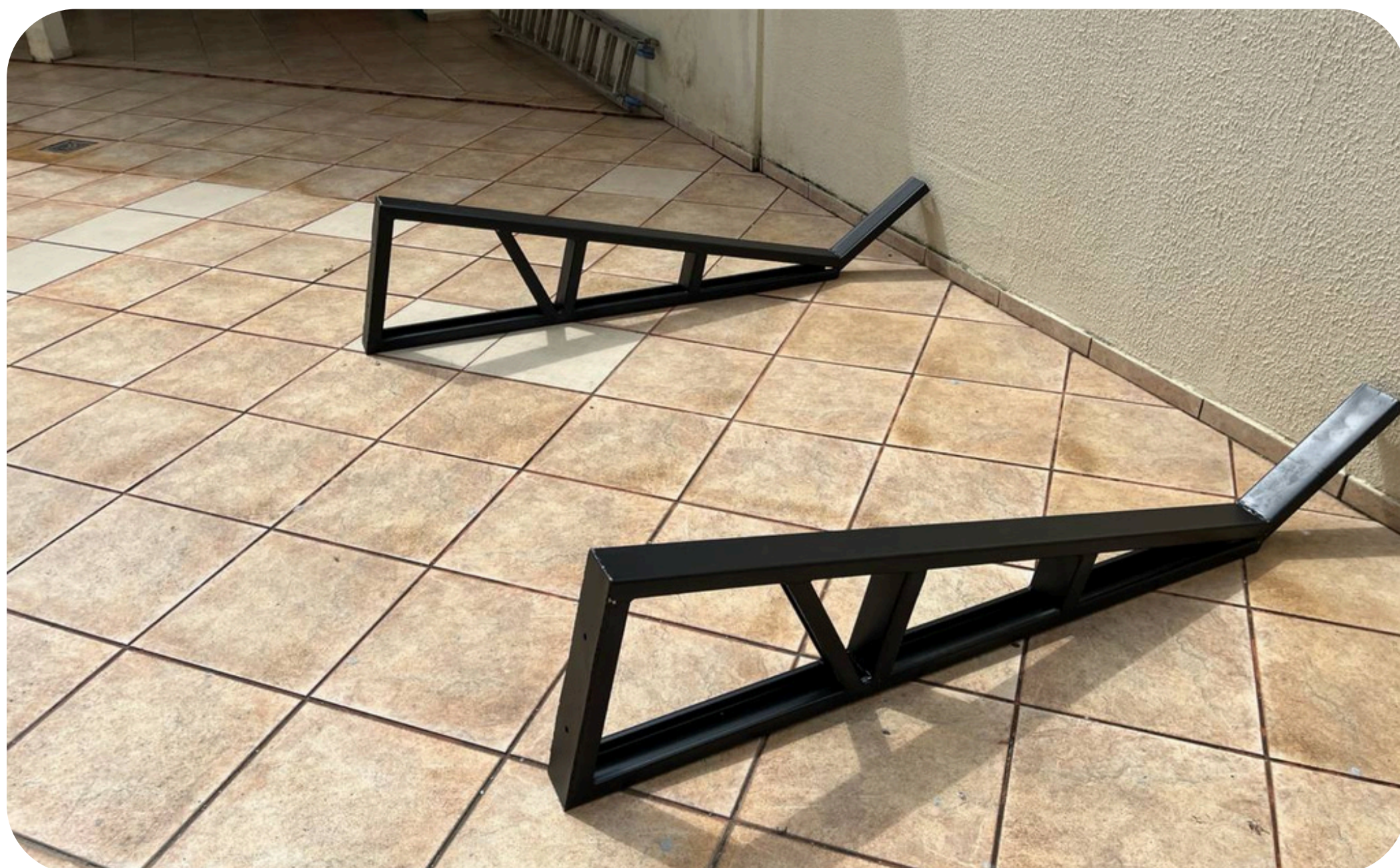
Imagem 01 - Estrutura principal bandeja de proteção
